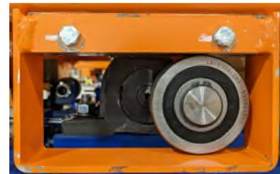
**10** Apriete los tornillos niveladores internos de manera uniforme manteniendo las poleas de elevación paralelas a la polea de la unidad hasta que las bandas de elevación estén correctamente tensadas. Si es necesario, ajuste los tornillos niveladores exteriores.
