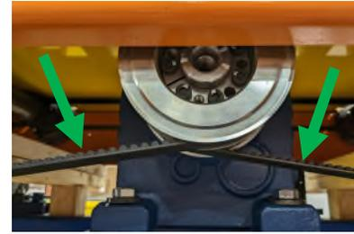
**7** Inspeccione la polea de elevación, los rodillos de leva y la polea de la unidad para ver si están desgastados o dañados. Reemplace si es necesario.
