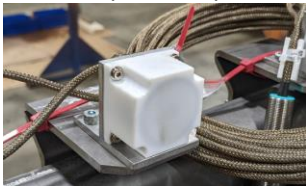
▲ Sensores y cable de proximidad de alta temperatura.
