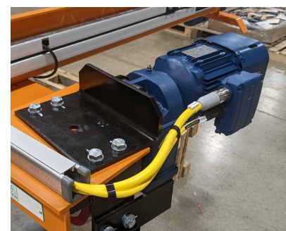
▲ Motorreductor de mesa giratoria montado.
